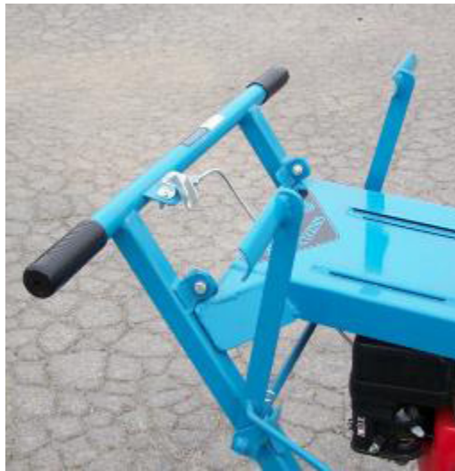
Fig. 3 Levier de frein appliqué et embrayage désengagé
