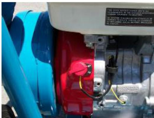
Fig. 7 Interrupteur d'arrêt
