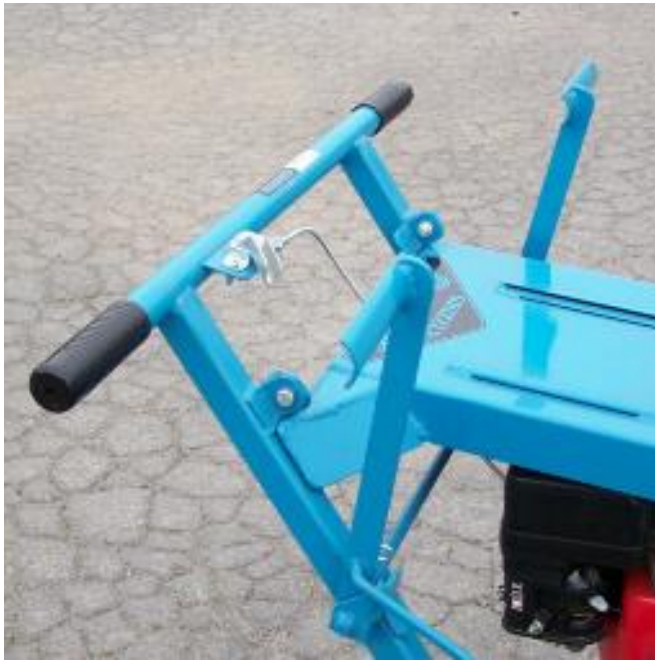
Fig. 3 Levier de frein appliqué et embrayage désengagé
