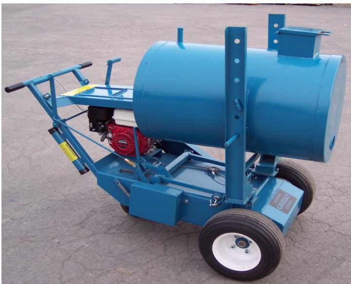
Fig. 7 Avec réservoir d'asphalte chaud
